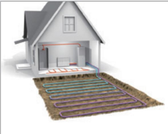
Bei dieser Methode wird die in den oberen Bodenschichten gespeicherte Sonnenenergie mithilfe im Grundstück vergrabener Rohrleitungen und einer Wärmepumpe nutzbar gemacht. Diese Lösung bietet sich an, wenn ausreichend Grundstücksfläche zur Verlegung des Flächenkollektors vorhanden ist.
